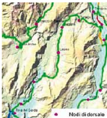
Dorsale di fibra ottica che serve la valle dei Laghi e il comune di Calavino.
